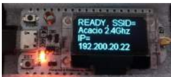
Figura 11: Gateway montado com um dos dispositivos Heltec LoRa
