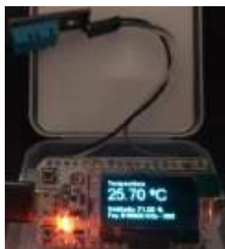
Figura 12: Heltec LoRa configurado como end-device com sensor DHT11
