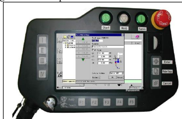
Figura 8 – Teach pendant usados em robôs Panasonic
