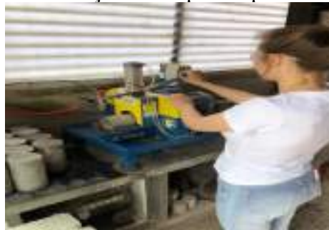
Figura 3 – Retificação de corpos de prova de concreto.
